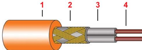
Экранированный нагревательный кабель с двойным покрытием и с внешней термостойкой оболочкой PVC.
