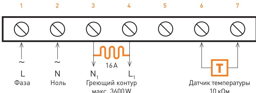
Подключите систему «теплого пола» к терморегулятору IQ THERMOSTAT после полного высыхания стяжки в соответствии с рекомендациями производителя. Начертите схематично места установки кабеля, воспользовавшись приложением на стр. 14 и зарегистрируйте систему. Процесс регистрации описан в Гарантийном талоне на стр. 15.
