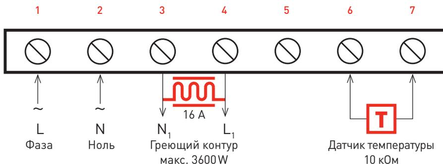
Подключите систему теплого пола к терморегулятору IQ THERMOSTAT после полного высыхания плиточного клея в соответствии с рекомендациями производителя. Начертите схематично места установки кабеля, воспользовавшись приложением на стр.14 и зарегистрируйте систему. Процесс регистрации описан в Гарантийном талоне на стр. 15.
