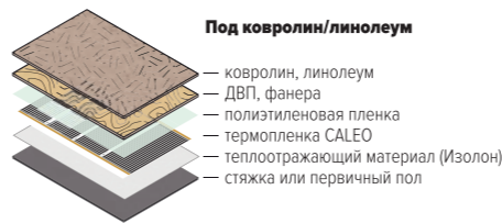
Рис. Схема монтажа теплого пола CALEO под ламинат, ковролин, линолеум
